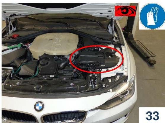
フロント補助バッテリー(12V)を外して、フロンガスを回収する。
