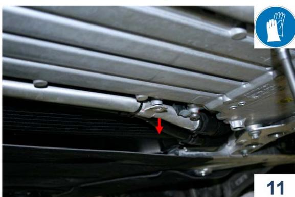
11. 冷媒ラインを固定しているボルトを外す。
