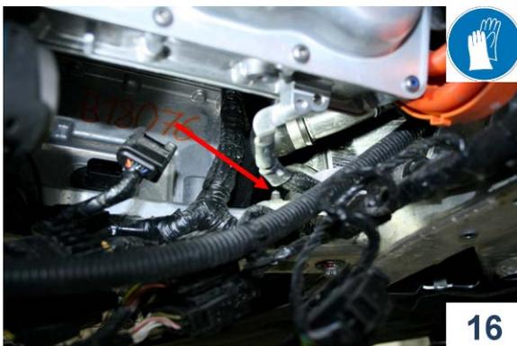
16. バッテリー前方を固定しているボルトを外すために、矢印のワッシャーをスパナで固定して外す。
