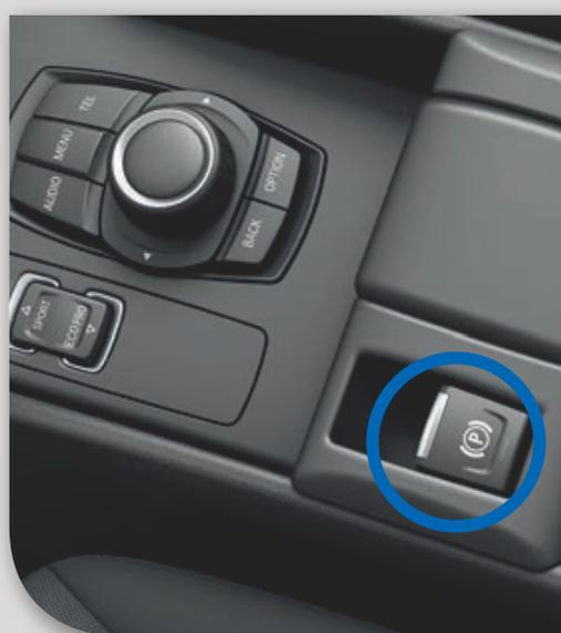
**2** スイッチを引き上げて電動パーキングブレーキを作動させます。
